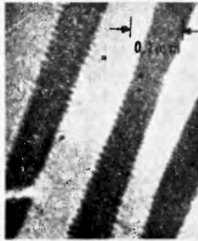
Rys. 6. Struktura domenowa cienkiej warstwy (500 Å) permalloyu (81% Ni, 19% Fe), obserwowana przy pomocy zjawiska Faradaya [67]
