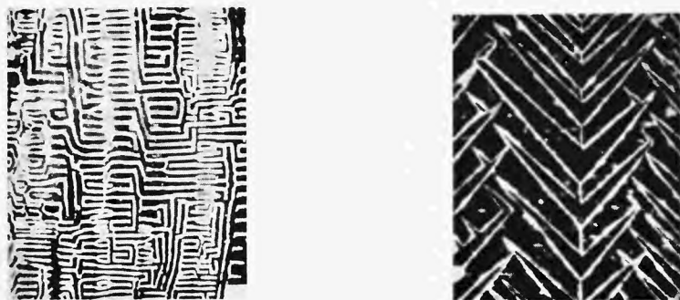
Rys. 2. Figury proszkowe na powierzchni (100) monokryształu FeSi po polerowaniu mechanicznym (a) i elektrolitycznym (b). Według [13]
