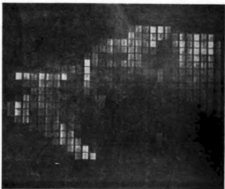
Rys. 23 Obraz otrzymany za pomocą urządzenia złożonego z 1200 elementów (transfluktor— komórka elektroluminezująca)
