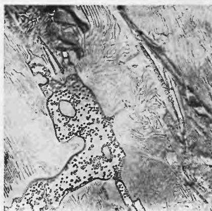
Fot. 12. Replika węglowa powierzchni stali węglowej. Powiększenie 2200 ×
