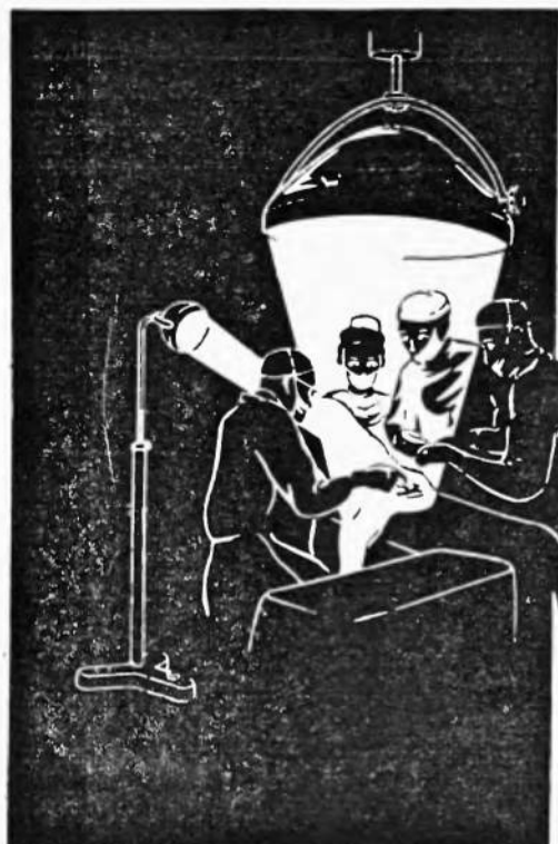
Rys. 15. Oświetlenie sali operacyjnej lampą „Pantophos” ze zwierciadłem eliptycznym i filtrem światła dziennego
