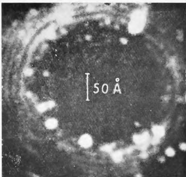
Rys. 4 Jonowy obraz helowy ostrza wolframowego; widoczne stopnie sieciowe płaszczyzn 011; r = 1000 \text{ \AA} , V = 23 \text{ kV} , p = 1,5 \cdot 10^{-2} \text{ tora} . T = 300 \text{ }^\circ\text{K}
