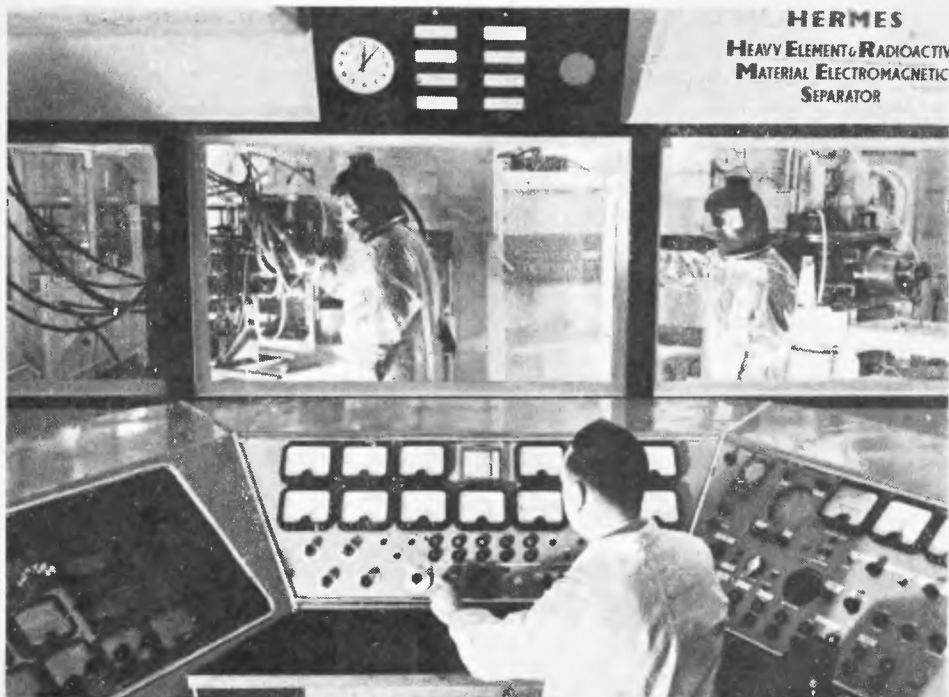
Rys. 6. HERMES — widok stołu kontrolnego (ciężkie pierwiastki, separator elektromagnetyczny radiopierwiastków)
