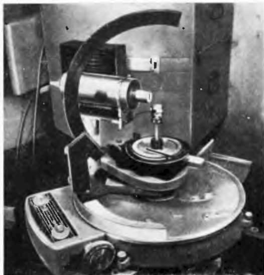
Fot. 15. Dyfraktometr neutronowy dla pojedynczych kryształów. Mały licznik \text{BF}_3 pod wysokim ciśnieniem jest umieszczony w sposób regulowany na łuku obrotowym. Jako kryształ zastosowano \text{BaTiO}_3 [95]
