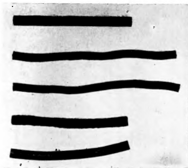
Fot. 19. Wpływ 850 cykli ciepłych na pręt uranowy. Metody obróbki plastycznej (od góry w dół): pręt odlany walcowany na gorąco, wyłaczany na zimno, wyżarzany w fazie \beta , utwardzany w fazie \beta [98]
