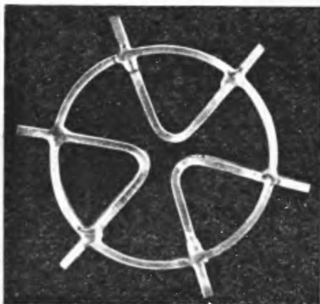
Fot. 3. Konstrukcja elementu paliwowego zawierającego uran silnie wzbogacony, przeznaczonego do wsadu reaktora BNL [38]
