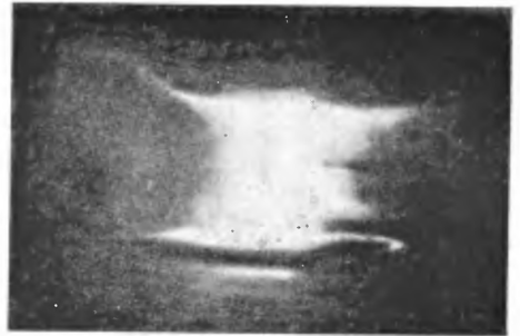
Rys. 7. Fotografia robiona za pomocą komórki Kerra w 2,2 \mu sec po rozpoczęciu wyładowania w deuterze. Początkowe ciśnienie p_0 = 1 mm Hg. Ekspozycja 0,2 \mu sec. Odległość między elektrodami 40 mm
