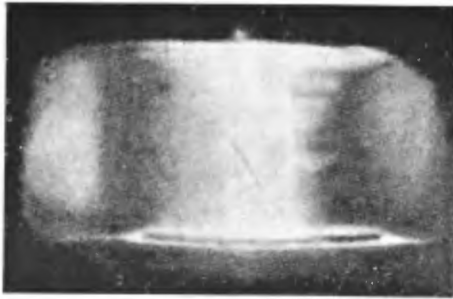
Rys. 6. Chwila kontrakcji słupa wyładowania. Ekspozycja: 0,2 \mu sec. Fotografię wykonano za pomocą komórki Kerra. Wyładowanie w wodorze przy ciśnieniu p_0 = 1 mm Hg. Odległość między elektrodami 45 mm. Średnica komory: 180 mm
