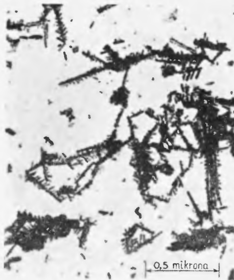
Rys. 14. Struktura proszku żelaza o średnim wydłużeniu ziarn 4,0 i natężeniu koercyjnym 1600 erstedów (wg P a i n e'a)
