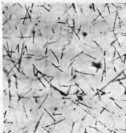
Rys. 25. Gwiazdki wywołane przez sole radu w emulsji. Długi cienki ślad na kliszy odpowiada protonowi wytworzonemu przez jedną z cząstek alfa w jakiejś reakcji jądrowej (38).
