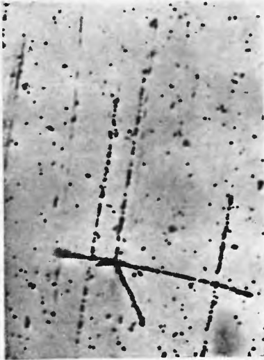
Rys. 31. Rozbicie jądra atomu azotu na cztery cząstki alfa przez deuteron o energii 8, 9 MeV zgodnie z równaniem:
