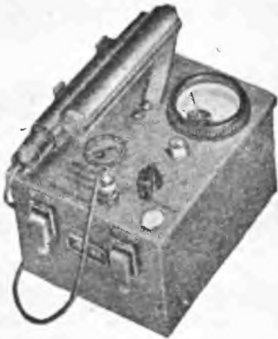
Rys. 3. Laboratoryjny dozymetr licznikowy na promienie \gamma i \beta (Nucleonics, 3,6)
