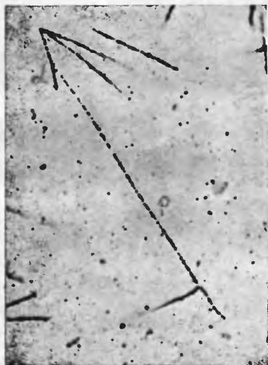
Rys. 26. Zderzenie cząstki alfa z protonem. W lewym górnym rogu kliszy widać gwiazdkę promieniotwórczą radioroturu. Jedna z cząstek alfa zderzyła się z protonem, którego długi ślad widzimy na kliszy (38).
